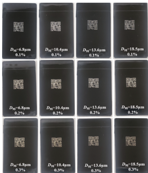
图5 不同炭黑粒径PA6材料的激光标记效果
